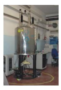
Modello Gemini, 300 MHz con magnete Oxford 7 Tesla, inverse e direct probe multinucleare. Esegue analisi (spettri  $^{1}$ H,  $^{13}$ C e  $^{31}$ P) monodimensionali e bidimensionali, omonucleari ed eteronucleari a temperatura ambiente o a temperatura variabile (-90° -150° C).
